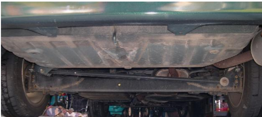
محور تیر و میله پانارد روی یک مزدا ۲۰۰۲ MPV
